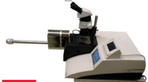
Cryo Ion Milling
